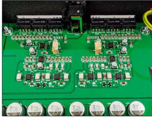
*Links: Gleich acht Spannungsregelschaltungen kümmern sich um die Versorgung des Gerätes
