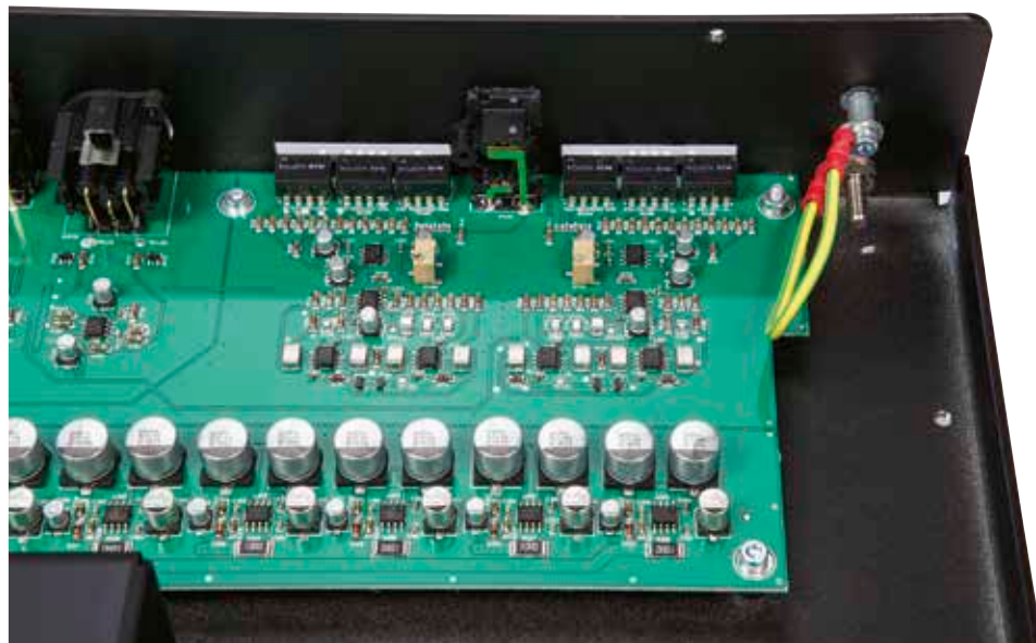
▲ Eine Flut von SMD-Bauteilen steckt auf der Platine, die kaum ein Drittel des Gehäuses einnimmt.
